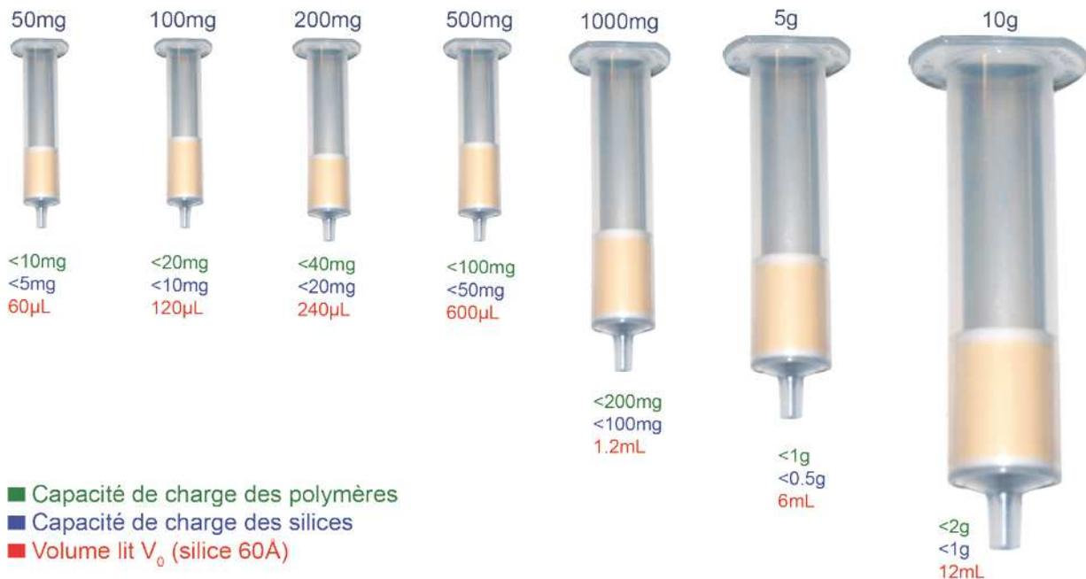
Une masse d'adsorbant trop élevée induit une élution incomplète des composés d'intérêt ou une dilution de l'échantillon par un volume d'élution trop important. Une masse d'adsorbant trop faible induit une rétention incomplète des composés d'intérêt que l'on retrouve dans la fraction de percolation ou dans le solvant de lavage. Ces deux situations conduisent à des taux de récupération plus faibles que prévus.
